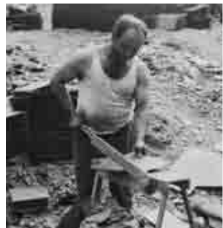
les méthodes d'extractions, de découpe et de transport ont considérablement évolué. Pour autant, un maître fendeur continue à un rythme d'environ 4.000 ardoises/jour depuis plusieurs générations.
