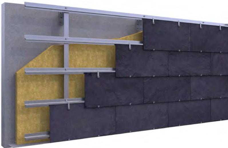
Caractérisé par son design contemporain, CUPACLAD® 201 Vanguard combine des ardoises épaisses de grand format et des crochets en acier inoxydable, offrant une composition limpide et moderne.
