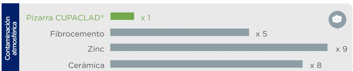
\*El estudio incluye el análisis de las diferentes etapas en la vida del producto: producción, transporte, instalación, uso y mantenimiento, y fin de vida ("De la cuna a la tumba") para 1 m<sup>2</sup> de fachada, y un año. Fuentes: Pizarra CUPACLAD® (<http://goo.gl/K5ILx8>); Fibrocemento (<http://goo.gl/OSjeV5>); Zinc (<http://goo.gl/EgWh6g>); Cerámica (<http://goo.gl/YO3c9U>).
